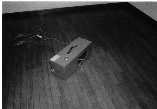
写真1 軽量床衝撃音発生装置
