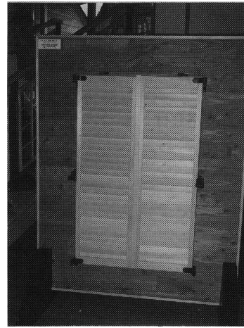
写真5 試作したよるい戸 (よるい戸閉, ガラリ開)
