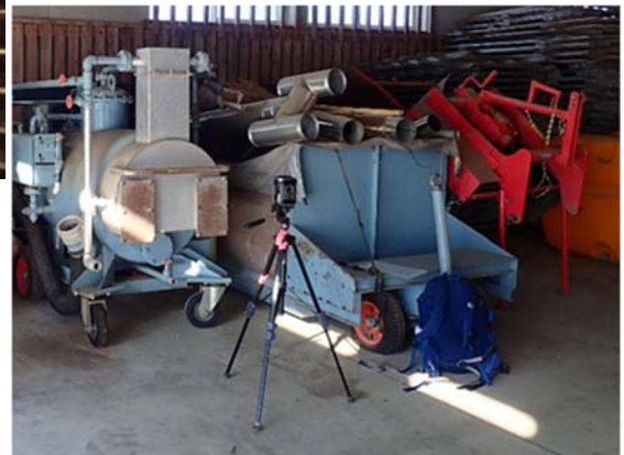
自動撮影カメラのねじ穴は市販の三脚と適合する
