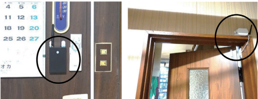
図2 人感センサ(左)と開閉センサ(右)
