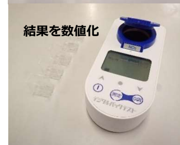
硝酸態窒素測定に用いた簡易測定器の例
