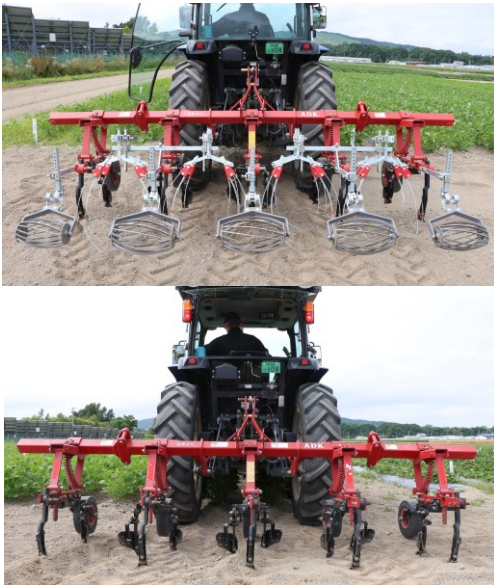
写真1 中耕・培土に用いたカルチ装置 中耕:除草タイン取り付け(上図) 培土:培土板を開いた状態(下図)
