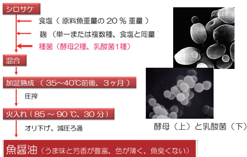
図1 発酵技術を導入した魚醤油の製造方法
