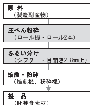
(A) 離処理の工程、(B) 原料、(C) ふるい分け後の処理物。
