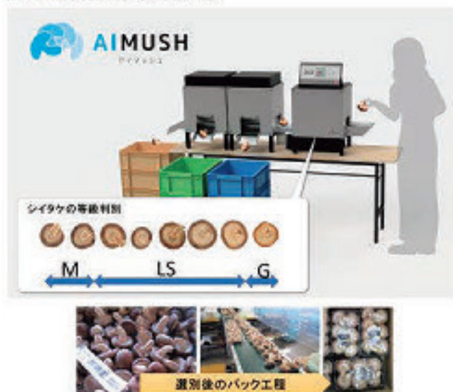
図3 等級判別装置（試作機）と選別後のパック工程
