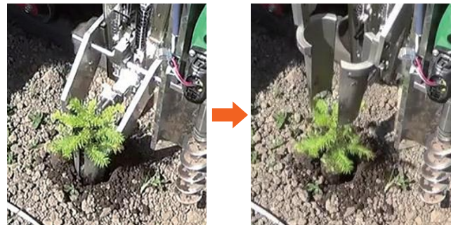
植付中の植栽機構 爪が開きながら上がって植え付ける
