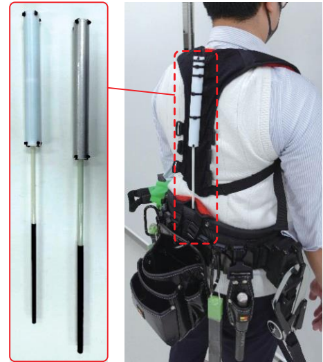
本補助機構の試作品を腰道具と併用した例
