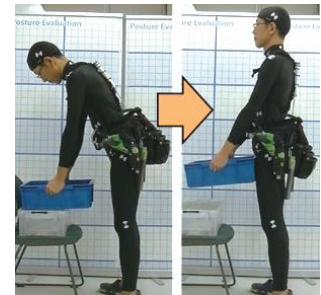
重りの持ち上げ動作で腰部の筋負担が減少
