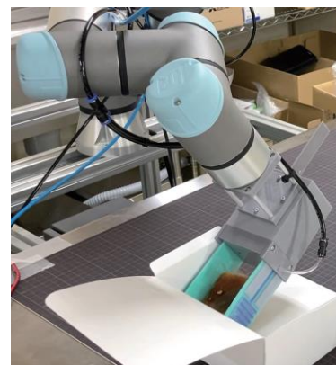
試作品による食品の 箱詰めの様子
